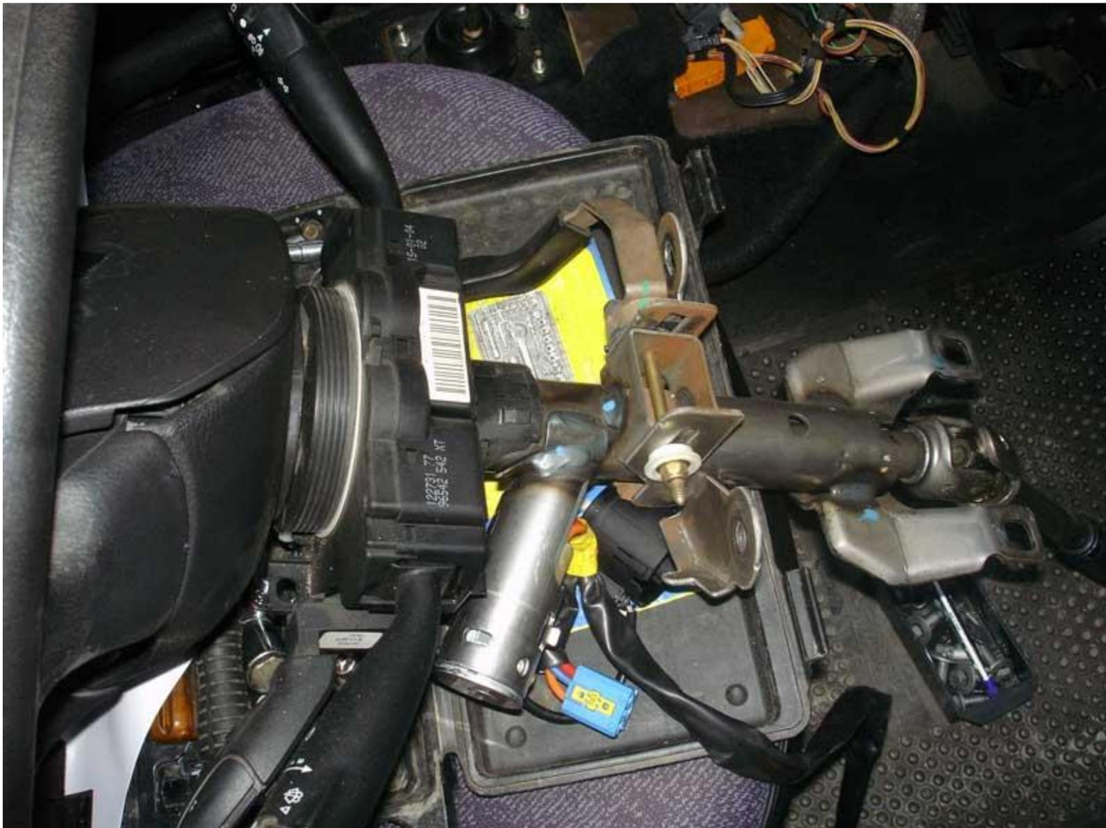
حالا باید اتصالات را از داشبورد آزاد کنید. اتصالات مربوط به بخش میانی (پشت کنترل هوا و ضبط) از سمت راست روی یک راهنما که بدنه دستگاه تهویه است آمده.
