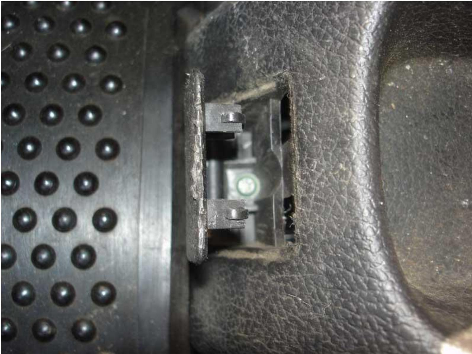
بعد از باز کردن پیچ انتهایی، تیکه پشتی کنسول رو از پشت به راحتی بلند کنید و فیش های شیشه بالابر رو باز کنید. اگر سیم کوتاه بود، با اهرم کردن قاب کلید های شیشه بالابر آنها را قبل از بلند کردن انتهای کنسول آزاد کنید. یادتون باشه شیشه بالا بر ها از پایین آزاد میشوند. پس از لیه اهرم کنید ولی از پایین به بالا بکشید. بعد از باز کردن کلید شیشه و جدا کردن قاب، نوبت به قسمت جلویی کنسول میشه. برای باز کردن این بخش باید شیشه بالابر جلو و فنک رو هم آزاد کنید برای شیشه بالابر جلو باید از پایین اهرم کنید
