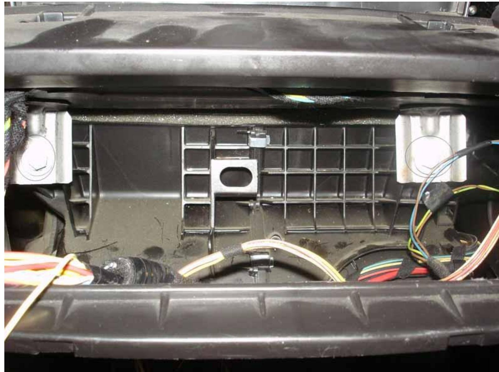
این ۲ پیچ وسط داشبورد را نگاه نداشتند، در واقع سیستم تهویه روی این ۲ پیچ سوار و به شاسی داشبورد متصل شده. موقع بستن یادتون باشه که میتونید برای میزون کردن سوراخ پیچ ها، سیستم تهویه رو کمی بالا پایین کنید بعد از باز کردن این پیچ ها نوبت به پیچ های جانبی میرسه که عکس هاشون رو بالا گذاشتم. این ۴ پیچ رو هم باز کنید ولی دست به داشبورد نزنید. برید سروقت پیچ پایین که پایه داشبورد است در عکس ببینید:
