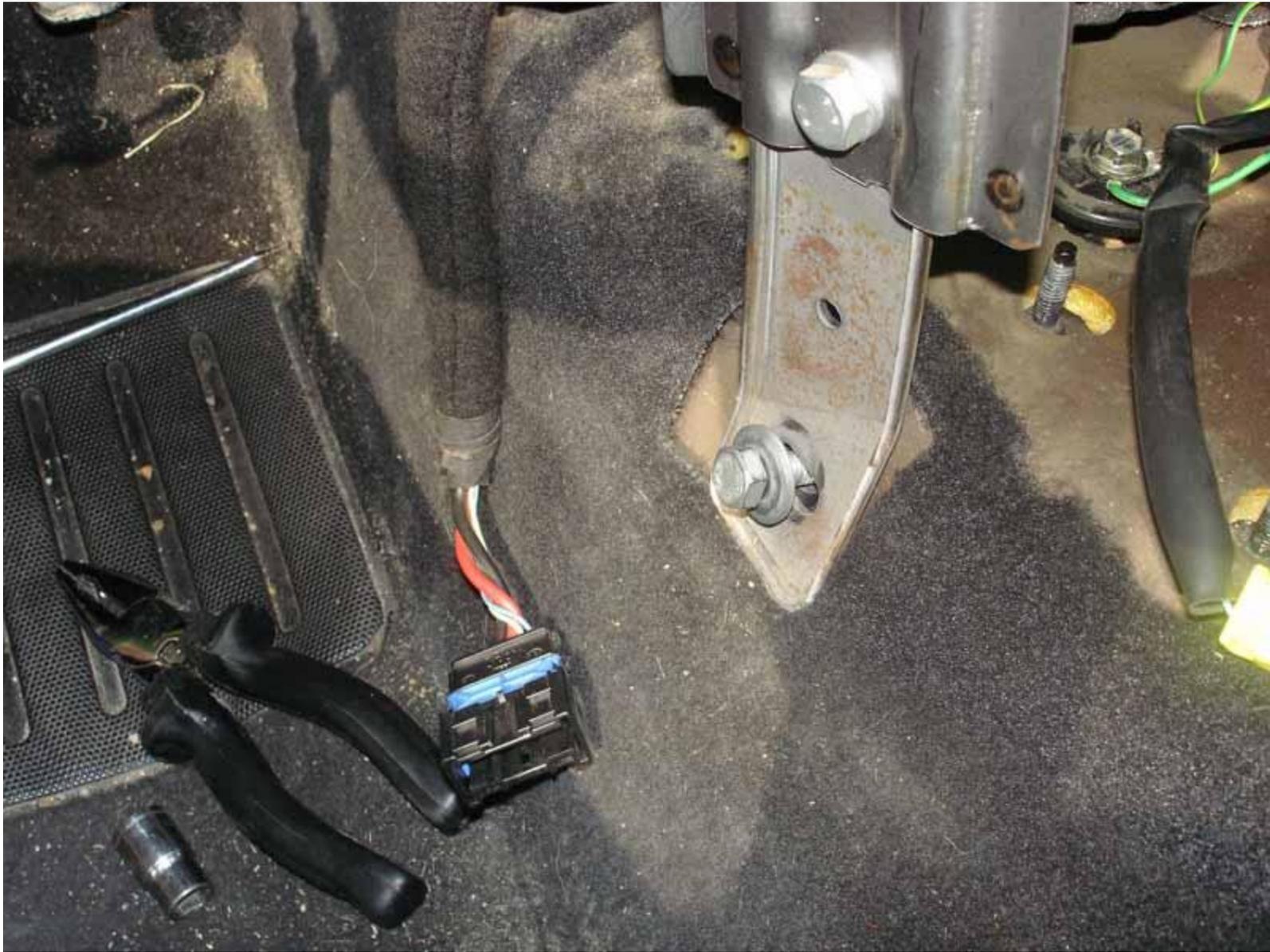
این پیچ پشت لبه کانسول میانی طرف راننده قرار گرفته برای باز کردنش هم میتونید کانسول را باز کنید و هم میتونید لبه رو به بالا بکشید (نمیشکنه) و پیچ رو باز کنید که من باز کردن کانسول رو پیشنهاد میکنم این رو هم اضافه کنم که برای باز کردنش شاید مجبور بشید ترمز دستی رو هم باز کنید و کمی جابه جا کنید. برای شروع باید ۲ پیچ بالای زیرسیگاری رو باز کنید
