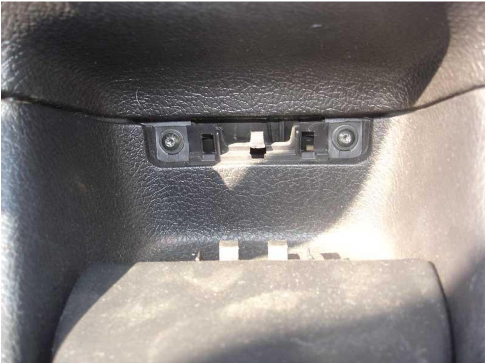
بعد پیچ انتهای کنسول که شیشه بالابر عقب و... بر آن سوار شده، باید پوشش پیچ رو از بالا باز کنید تا به پیچ دسترسی داشته باشید
