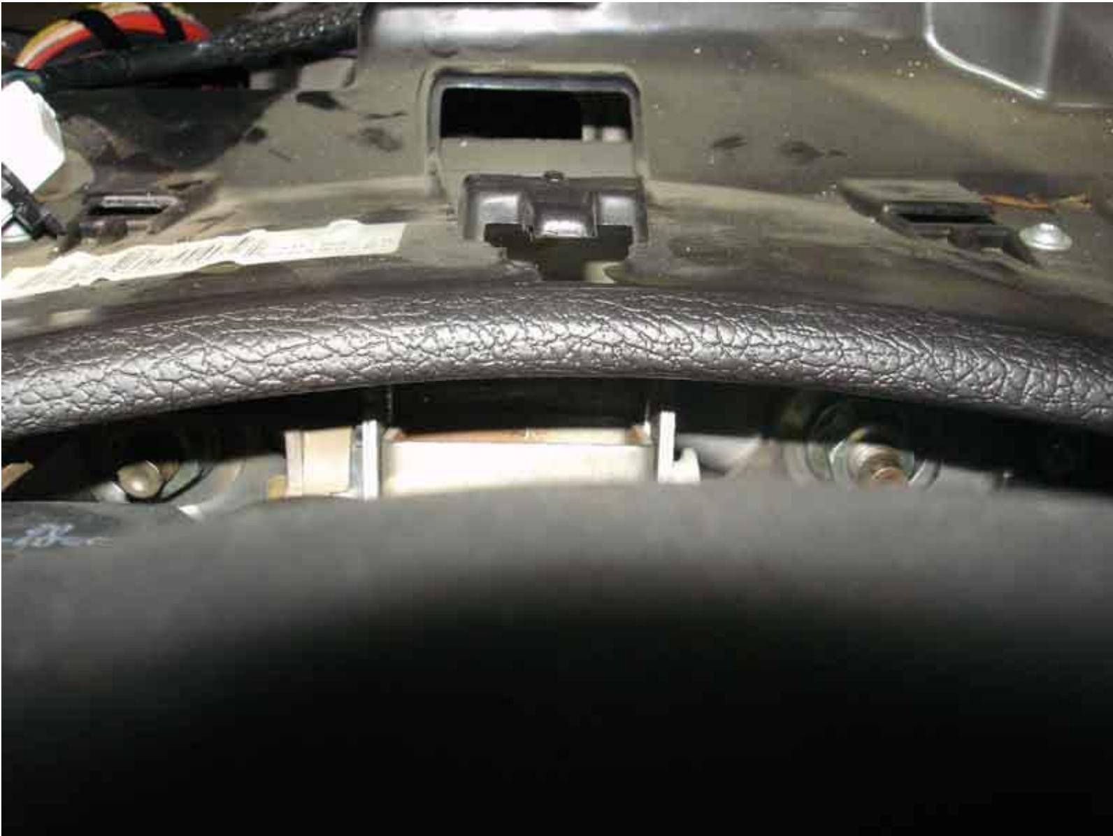
بعد از باز کردن این ۴ پیچ و پیچ و مهره زیر، تلسکوپ‌پی آزاد شده!
